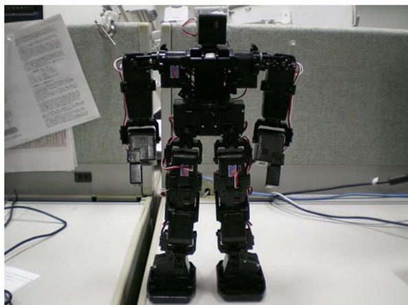
図. 4: 製作した MANOI AT01 のフレーム部
